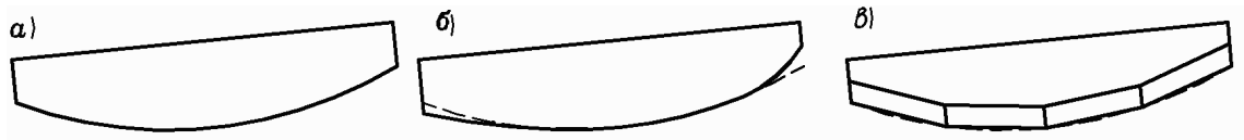
Рис. 1.18. Применяемые формы ножей. a — дугообразный нож, с постоянным радиусом кривизны; б — составленный из трёх дуг разного радиуса; в — нож, составленный из четырёх пластин.
